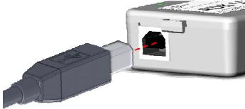
2. Conecte a extremidade do tipo “B” do cabo USB à unidade de aquisição
