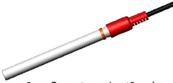
9. Conecte os bastões à unidade de aquisição. O bastão de retorno deve ser conectado ao contato vermelho
