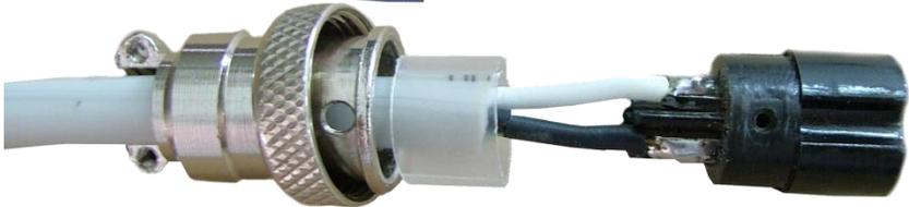
As vias do cabo devem ser soldadas ao conector circular conforme ilustração.
