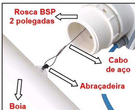
b) Prenda o cabo de aço e a boia utilizando a abraçadeira. Manobre o cabo com cautela, evite soltá-la de uma vez quando esticado, isto pode danificar o Mecanismo de medição;
