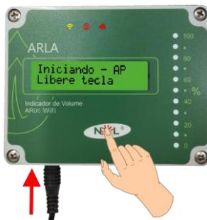
A partir deste momento as configurações de rede do AR06 WiFi podem ser ajustadas quando o seu dispositivo móvel for comandado a conectar-se à rede provida por ele.
