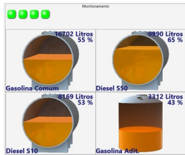
Representação de quatro indicadores de volume e quatro indicadores de vazamento.
