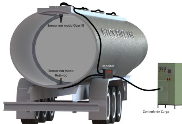
O sistema de detecção do sensor tem funcionamento baseado no princípio óptico de reflexão/refração da luz sobre um prisma. Esta característica, associada a detalhes de construção mecânica do dispositivo, garantem que não haverá nenhum contato direto do circuito elétrico com o líquido em carga/transporte.
