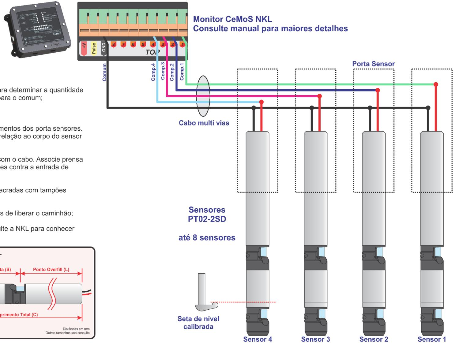
Utilize cabo 0,75 mm<sup>2</sup> com vias numeradas ou coloridas. Para determinar a quantidade de vias considere uma via para cada sensor mais uma via para o comum;
