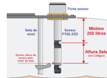
Ajuste a altura do sensor para que o canal de marcação localizado próximo da ponta fique na mesma altura da seta calibrada do caminhão.
